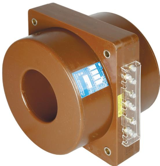
Трансформатор тока ТЛК-СТ-10-ТШЛП (ТШЛП-10) шинный предназначен для передачи сигнала измерительной информации измерительным приборам и устройствам защиты и управления, для изолирования цепей вторичных соединений от высокого напряжения в комплектных электрических устройствах внутренней установки (КРУ, КРУН, КСО) переменного тока на класс напряжения до 10 кВ.
